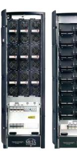
EI SAI TRIMOD 30kVA está constituido por 9 Módulos de Potencia de 3,4 KVA Las Baterías se alojan en Bastidor independiente (hasta16 Módulos de baterías) Para obtener grandes autonomías se pueden conectar alojamientos baterías adicionales
